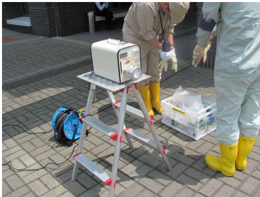
ダストサンブラによる空气中放射能濃度測定
