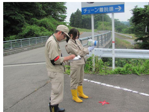
電離箱線量計による空間線量測定
