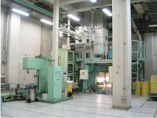
写真6 巨大な圧縮機。床にはラミネート濾紙が敷き詰められている
